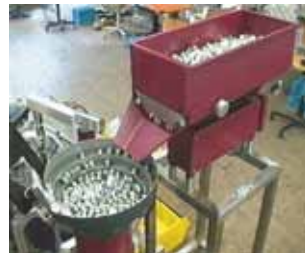
Alimentation par bol vibrant avec trémis de stockage
