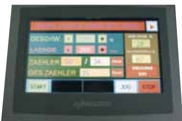
Écran tactile pour la configuration de tous les paramètres
