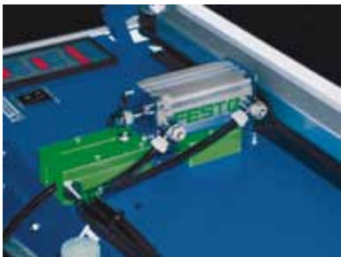
En option : commande pneumatique de la pipette d'aspiration.
